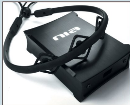
Это устройство называется Neural Impulse Actuator. Оно умеет распознавать мимику и претворять мысленные команды, с помощью которых можно управлять курсором на экране. Кстати, сейчас уже продается по цене около $200.
